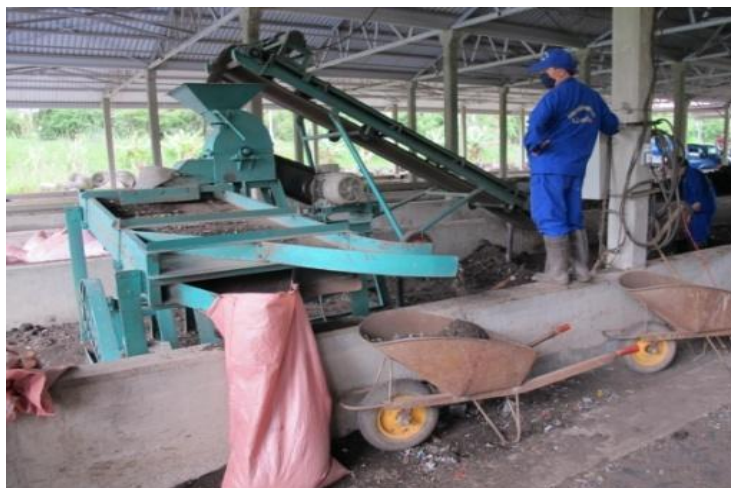
Hình 6.14. Phân bùn bể tự hoạt được đưa về xử lý cùng bùn của Trạm xử lý nước thải Đà Lạt, làm phân vi sinh
