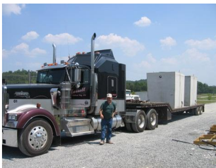
Hình 2.10. Chở bể tự hoại BTCT đúc sẵn từ nhà máy ra hiện trường
