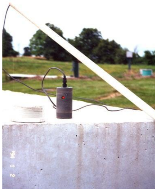
Hình 2.19. Kiểm tra chiều dày lớp bùn cặn bằng đầu dò siêu âm
