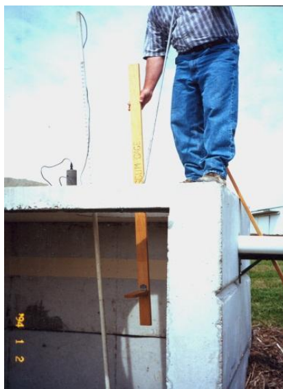
Hình 2.17. Kiểm tra chiều dày văng nổi bằng thước gỗ (Nguồn: MDWPC, Loudon T. và nnk, 2005)
