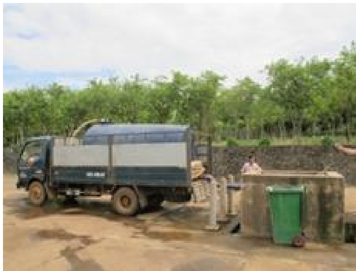
Hình 6.13. Phân bùn bể tự hoại được đưa về xử lý cùng nước thải tại Trạm xử lý nước thải Buôn Ma Thuột
