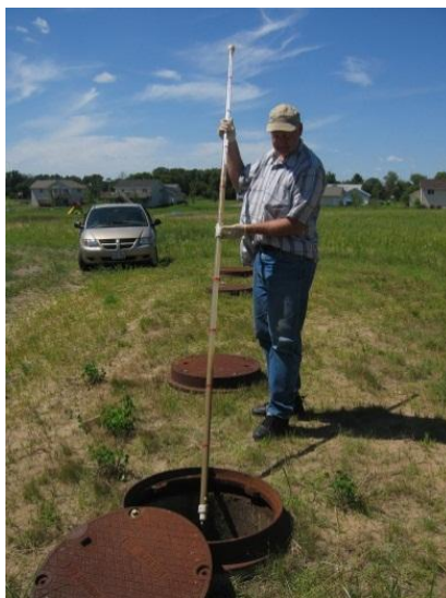
Hình 2.16. Kiểm tra chiều dày lớp bùn cặn bằng ống nhựa trong suốt (Ảnh: Nguyễn Việt Anh, 2005)
