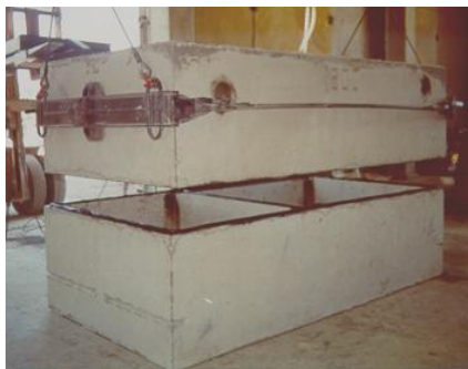
Hình 2.9. Bể tự hoại BTCT đúc sẵn bằng công nghệ va rung, được ghép từ hai khối bằng gioăng cao su chuyên dụng
