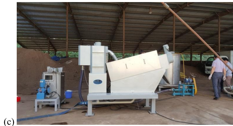
Hình 6.10. Thiết bị làm đặc bùn kiểu trục vít kết hợp đĩa ép đa tầng Sơ đồ nguyên lý hoạt động; (b) Chi tiết thiết bị tách nước bằng trục vít và hệ đĩa đa tầng; (c) Máy tách nước đã lắp đặt (Nguồn: Công ty ARK, Hàn Quốc)
