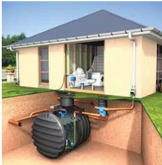
Hình 1.20. Thu gom nước mưa quy mô hộ gia đình tại Đức
