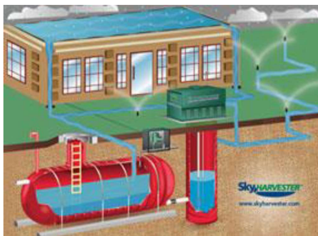
Hình 1.15. Hệ thống thu gom và sử dụng nước mưa trong trường học.
