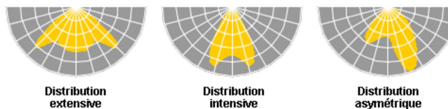
Hình 67. Các dạng phân phối ánh sáng cơ bản
