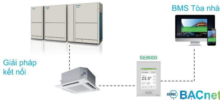
Hình 4.24 – Tích hợp với VRF/VRV để tối ưu hóa quản lý CLKKTN
